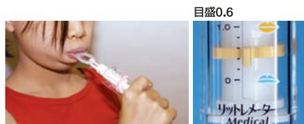
マウスピースを装着した状態で水平方向にゆっくりと牽引し、唇からマウスピースがはずれそうになった時の値が、口唇の閉鎖力の値です。
